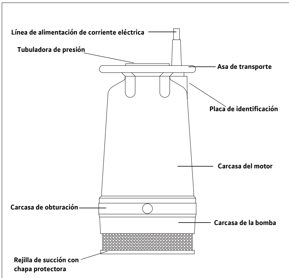
Fig. B-1: Estructura KS37Z
